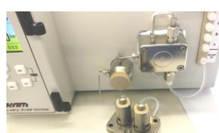
Двухпоршневая конструкция насосной головки S1125 и интегрированная электронная система компенсации разницы сжимаемости обеспечивают предельно высокую стабильность потока для любых растворителей и их смесей
