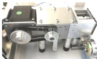
Вместо обычного электромотора S1125 оснащен мощным шаговым двигателем, который обеспечивает предельно высокую точность потока во всем диапазоне скоростей и давлений
