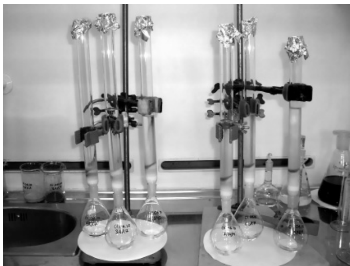
Рисунок 14. Шесть проб в параллели: хорошая производительность. Видно, насколько сильно окрашены слои силикагеля — экстракты действительно очень грязные. На заднем плане видны стаканчики со слоем осушителя, из которых переносились экстракты.
