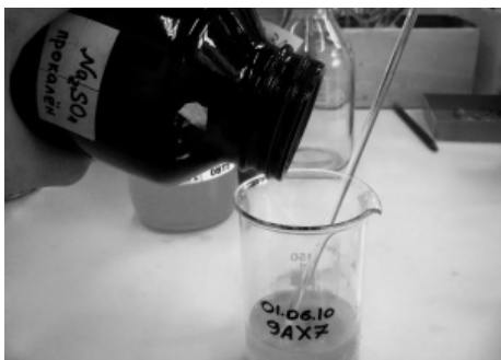
Рисунок 12. Добавляем осушитель, ждем, гексановый слой декантируем с плотного осадка.
