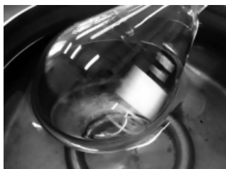
Рисунок 15. Растворитель из очищенных экстрактов отгоняем при помощи роторного испарителя примерно до 0.5 мл — вот так этот объем выглядит в колбе на 100 мл.
