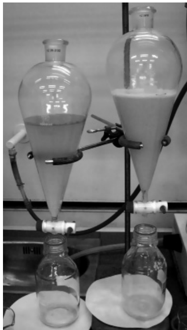
Рисунок 6. Более чистый водный образец (слева) экстрагируется нормально. Экстракция эмульсии (справа) приводит к появлению геля и пены.
