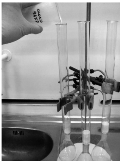
Рисунок 13. Переносим на предварительно подготовленную многослойную колонку с импрегнированными силикагелями для адсорбционной очистки.
